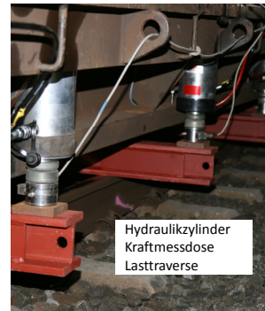
Lasteinleitung auf der Brücke
