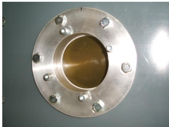
**Abb. 2** Flansch zur Sensorankopplung an das zu untersuchende Material
