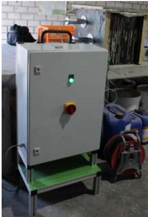
**Abb. 8** Mikrowellenspektroskopisches Messsystem für den Einsatz im Betonfertigteilwerk
