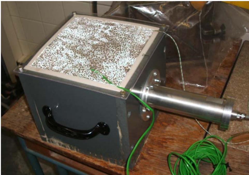
**Abb. 1** Messsystem zur Erfassung des Hydratationsprozesses
