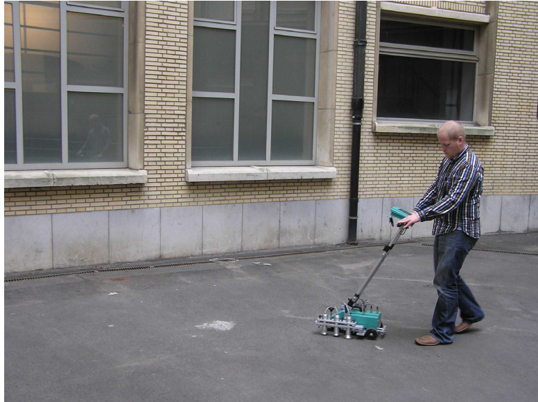
Abb. 4 Feuchtescan auf asphaltierter Stahlbetondecke
