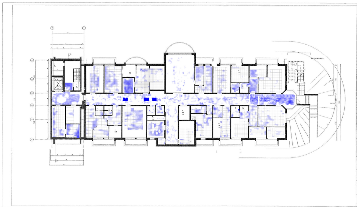
Abb. 10 Kombination von Mikrowellenscan und Rasterfeuchtemessung im Kellergeschoss eines Pflegeheims
