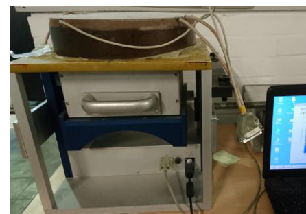
Abbildung 1: Foto der NMR-Mouse PM-25 4 während der Messung der Estrichprobe.
