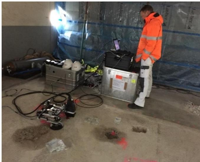
Abbildung 1: Aufbau des mobilen LIBS zur Messung der Chlorkonzentrationen
