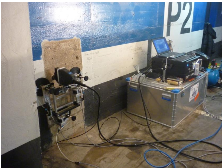
Abb. 12. und 13. Einsatz mobiles LIBS in einem Parkhaus; links Gesamtansicht und rechts mobiler Scanner an Wandfläche
