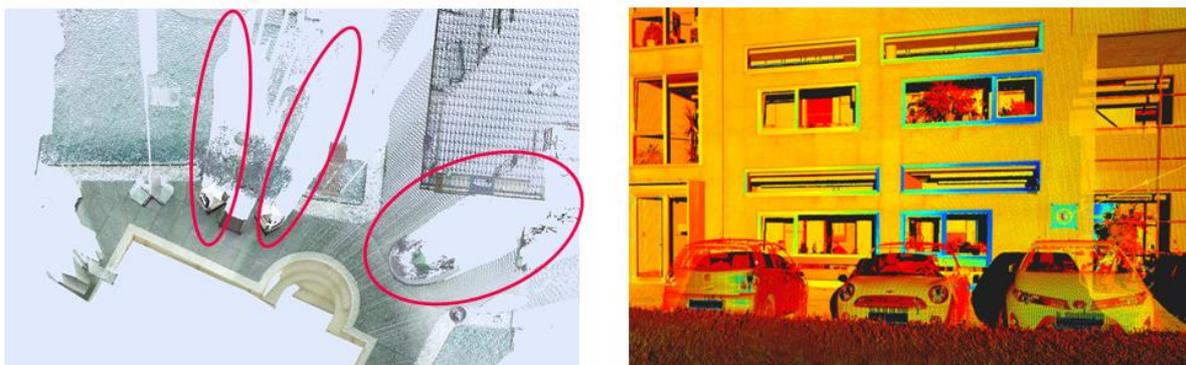
**Abb. 1.** Scanschatten (rot) bei der Aufnahme (links) und „schwarze Löcher“ an der Position der Fahrzeugkennzeichen, verursacht durch Totalreflexion (rechts)
