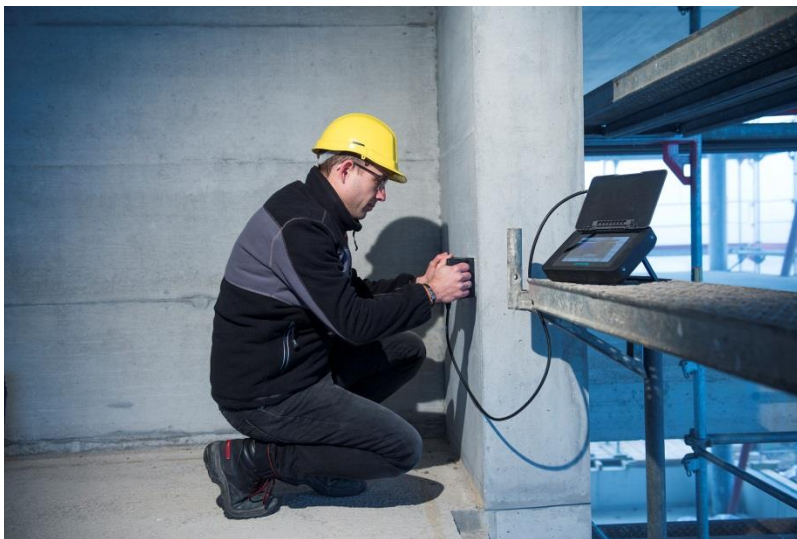
Abbildung 1: Ultraschallprüfung exemplarisch für die praktische Anwendung moderner ZfPBau.
