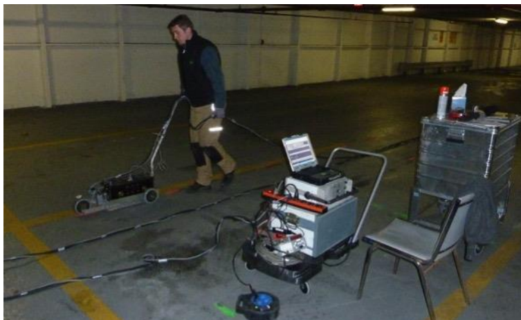
Abb. 2: Line-Scanning-System (Elektromagnet, kabelgebundene Signalübermittlung)
