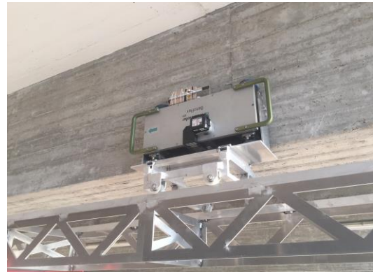
Abb. 10: Prüfsystem BetoFlux zur Lokalisierung von Spannstahlbrüchen auf Schienensystem
