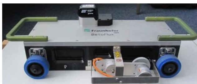
Abb. 4: System BetoFlux (kabellos, Messrichtung in Spanngliedachse)
