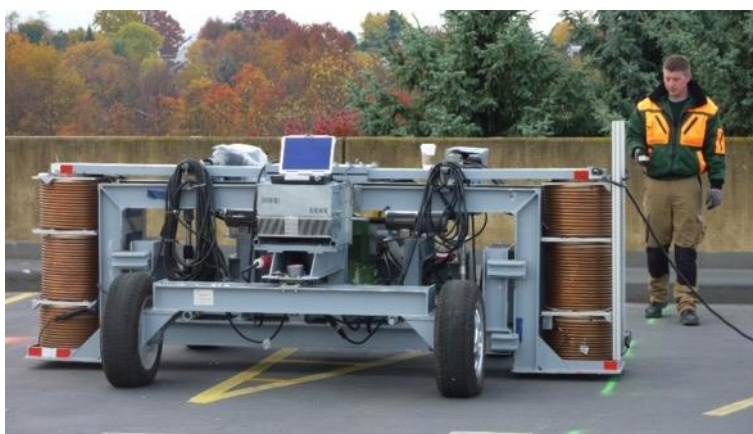
Abb. 3: System Mobi-Rem (Großmagnet, Messrichtung quer zum Spanngliedverlauf)
