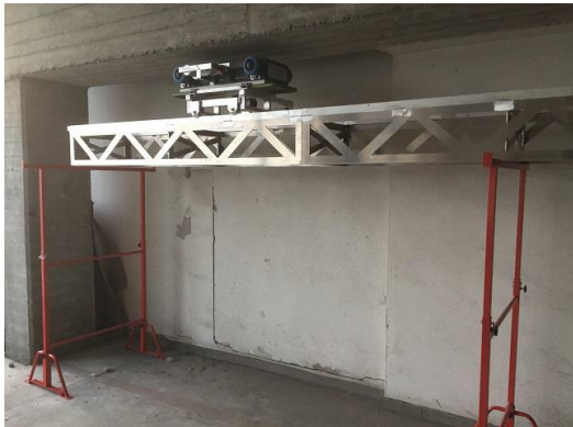
Abb. 10: Prüfsystem BetoFlux zur Lokalisierung von Spannstahlbrüchen auf Schienensystem
