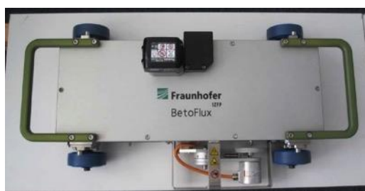
Abb. 4: System BetoFlux (kabellos, Messrichtung in Spanngliedachse)
