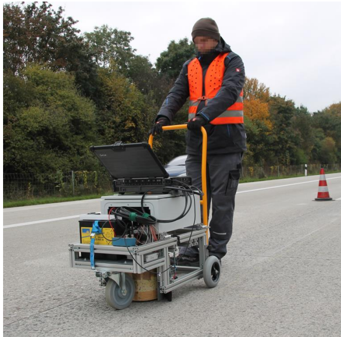
Abb. 3. Impakt-Echo-Scanner-Prototyp beim Einsatz auf einer Betonfahrbahn.
