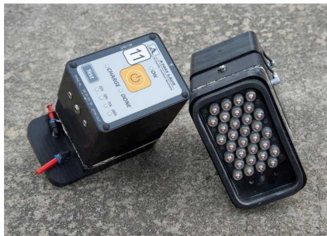
Abb. 2: LAUS-Prüfkopf mit 32 Punktkontakttransducern.
