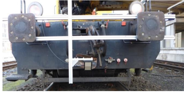
Abb. 3 Dopplerradar zur Wegaufzeichnung, befestigt an den hinteren Puffern der GAF (Foto: DB E&C, UGG, I.TPU(T)).
