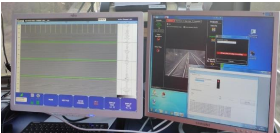
Abb. 4 Mit Radargrammen synchronisiertes HD Video (Foto: DB E&C, UGG, I.TPU(T)).
