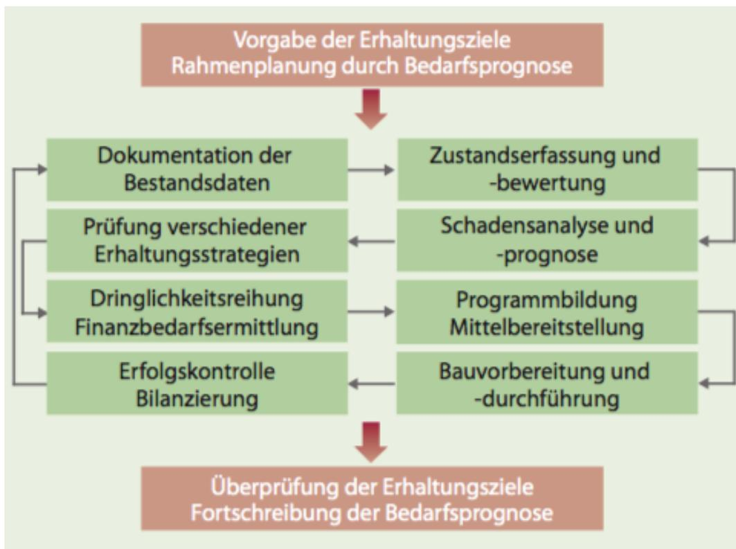
Abb. 4: Ablaufschema im Rahmen des Bauwerksmanagements (BASt 2008)
