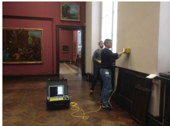
**Abb. 7: Zwinger Dresden (links) sowie Radaruntersuchungen auf oberflächennahe Lüftungsschächte (rechts)**
