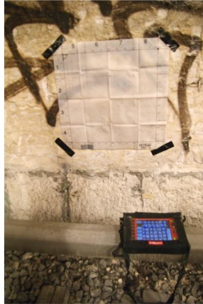
**Abb. 9: Ermittlung der Bewehrungslage vor Kernbohrung im Rahmen der Bestandsanalyse von Hintergleiswänden eines U-Bahnhofes**
